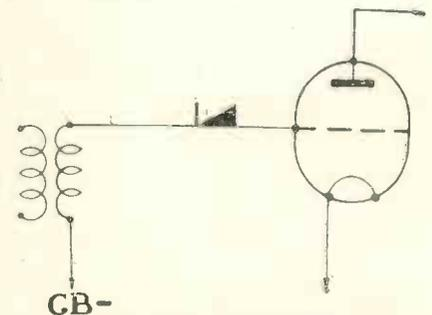
Fig. 4. Grid current rectifier.
