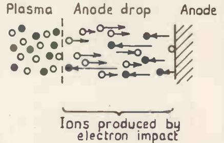
Fig. 20. The anode drop.
