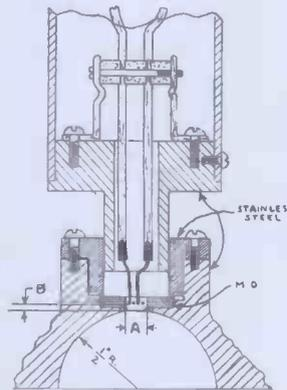
Fig. 3. Thermionic tungsten cathode.
