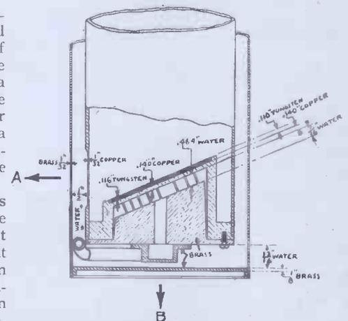
Fig. 4. Tungsten target.
