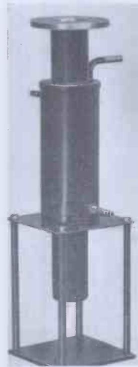
Fig. 6. Single-stage mercury diffusion pump.
