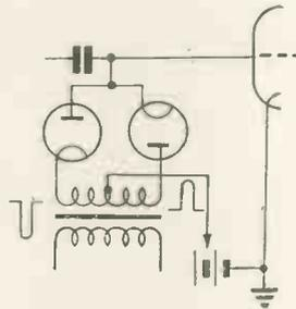
Fig. 15. Diode clamp circuit
