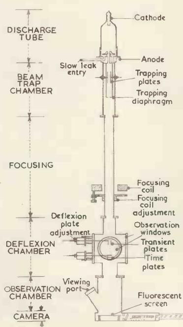
Fig. 1. The oscillograph
