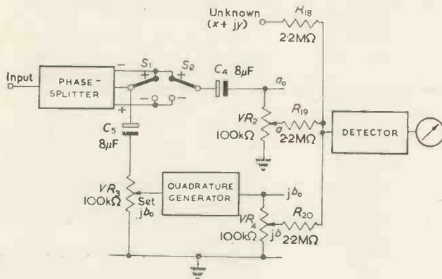
Fig. 1. The a.c. potentiometer
