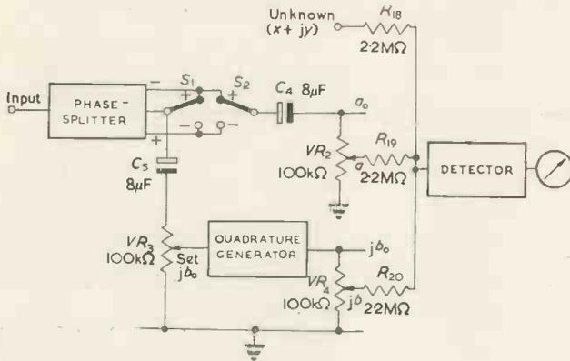
Fig. 1. The a.c. potentiometer
