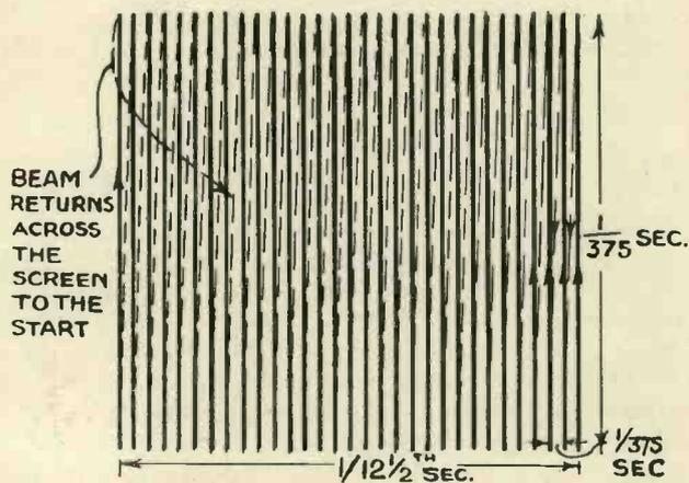
FIG. 6.—THE ACTUAL PATH OF THE BEAM ACROSS THE SCREEN.
