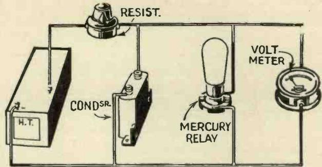
FIG. 5.—THE CIRCUIT FOR MOVING THE BEAM.
