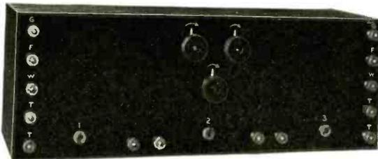
**3-STAGE RADIO-FREQUENCY AMPLIFIER TRANSFORMER COUPLED**
