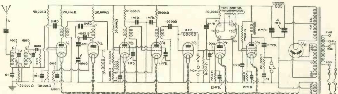
**SEVEN-VALVE CIRCUIT OF THE SEVENTY-SEVEN SUPER**
