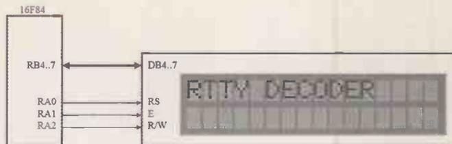
Fig. 14. LCD wiring diagram.
