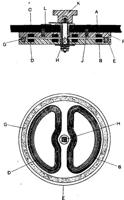
Fig. 14. A D type variometer.
