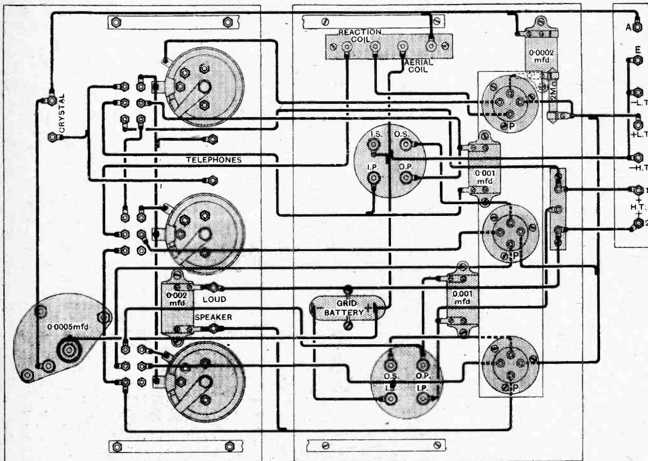
Fig. 5.—The complete wiring diagram.
