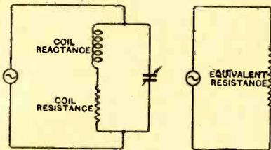
EQUIVALENT RESISTANCE OF A PARALLEL TUNED CIRCUIT
