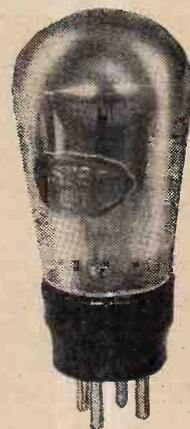
New high-voltage mercury vapour rectifier—the Osram G.U.1.
