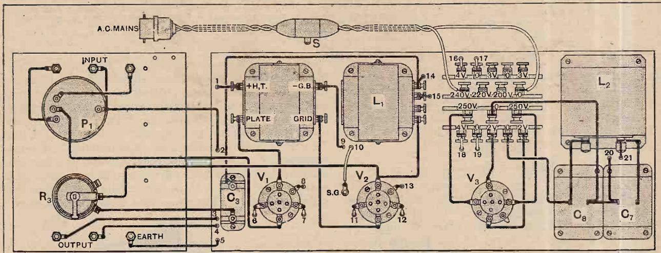
Fig. 2.—The practical wiring plan.
