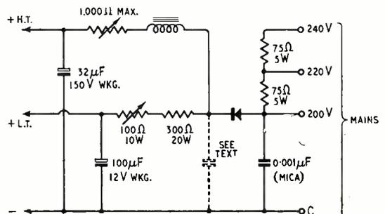
Fig. 1. Supply circuit using metal rectifier.
