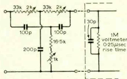
Fig. 7. Twin-T filter for 68kHz.
