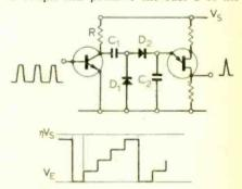
Fig. 10. Diode-pump divider.
