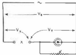
Fig. 111 : Simple neon-lamp impedance checker
