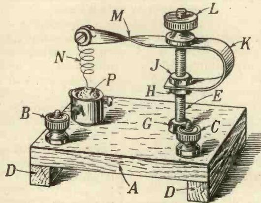
Fig. 15.—The crystal detector.
