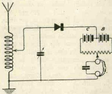
Fig. 1.—A simple potentiometer circuit.
